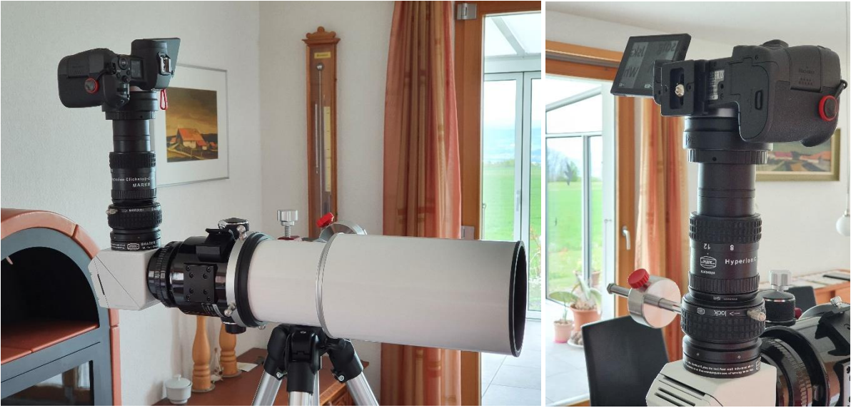
Dispositif de photographie incluant le prisme de Herschel.
