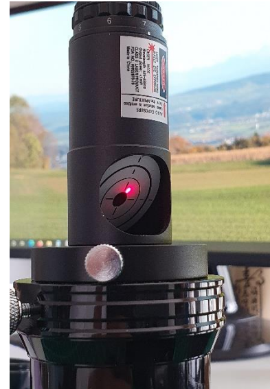
A gauche : Celestron Star Diagonal. Au centre : Le renvoi intégré au setup de mesure. A droite : L'erreur de positionnement du faisceau laser sur le chemin du retour.
