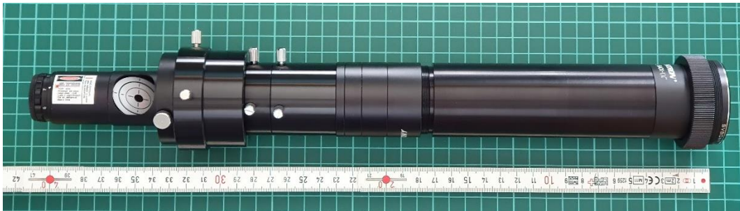
Dispositif de mesure sans le renvoi coudé à tester.
