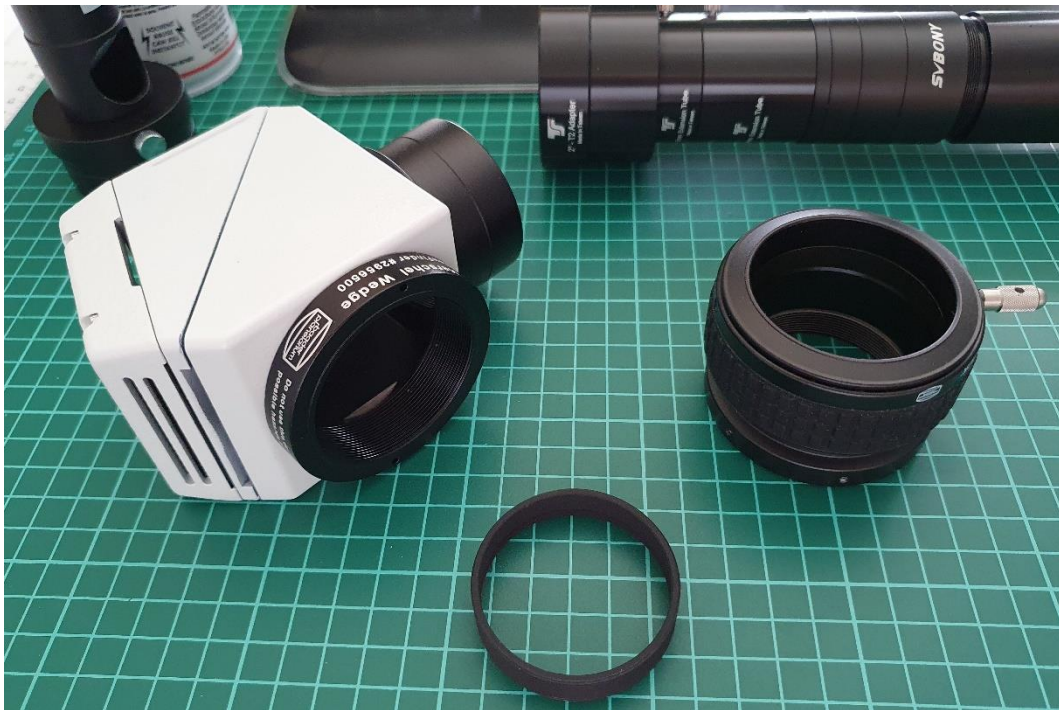
Prisme de Herschel Baader. Le chemin optique total une fois positionné sur le setup de mesure est de X + Y = 475\text{mm} .
