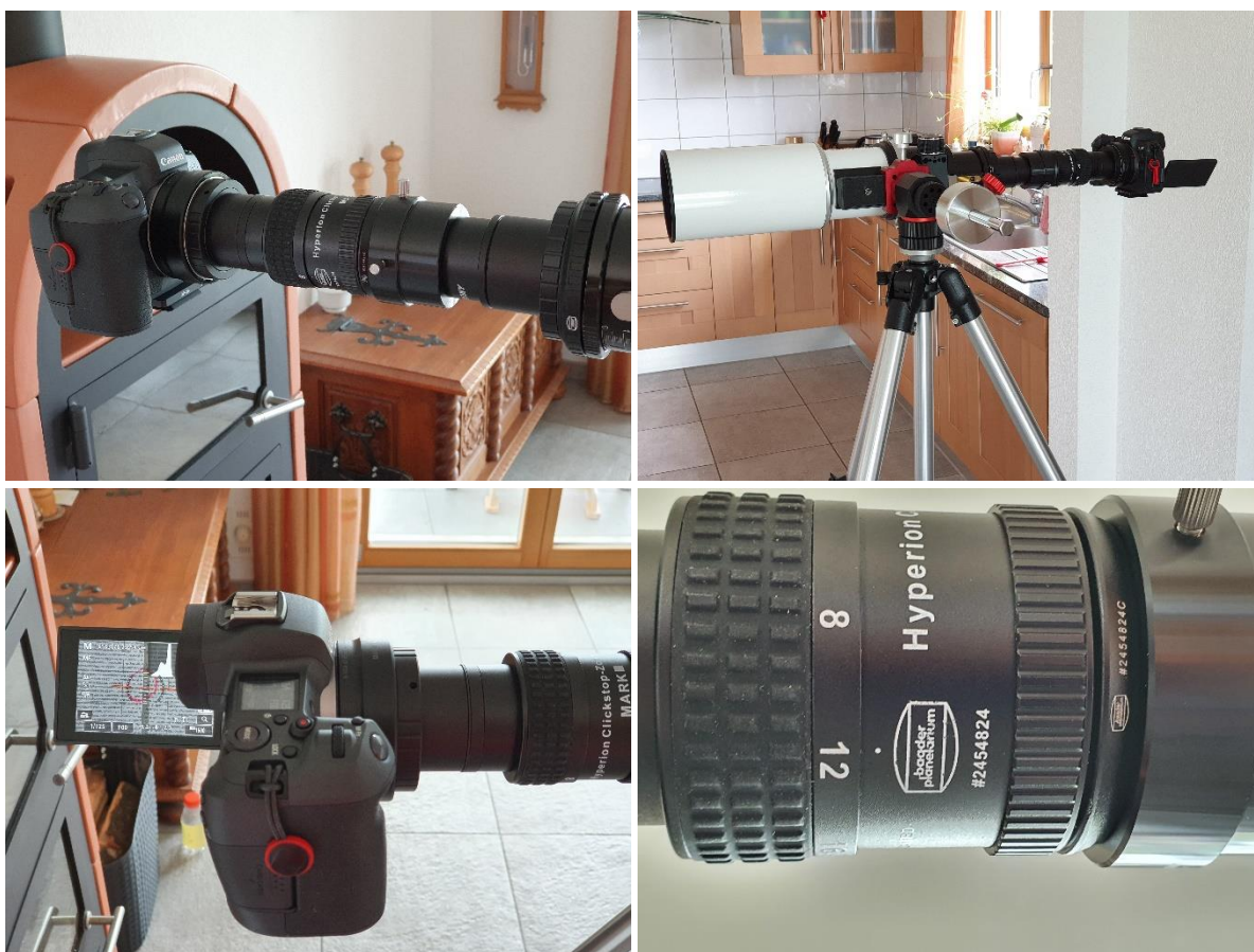
Dispositif de photographie totalement axial, sans prisme de Herschel.
