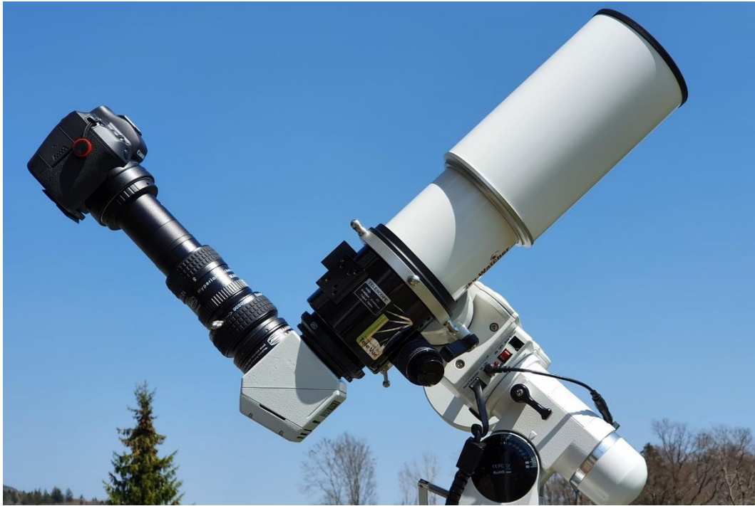
Setup d'observation solaire. Technique de projection par oculaire.
